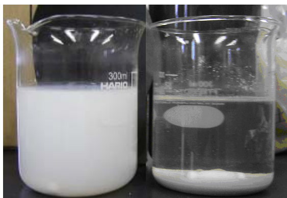
写真 1 PS 灰による水性塗料液の凝集沈殿 左：1%水性塗料液 右：PS 灰を添加した 1%水性塗料の凝集沈殿
