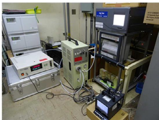
写真 静岡県三次基準器による下田市役所測定局でのオゾン計校正
