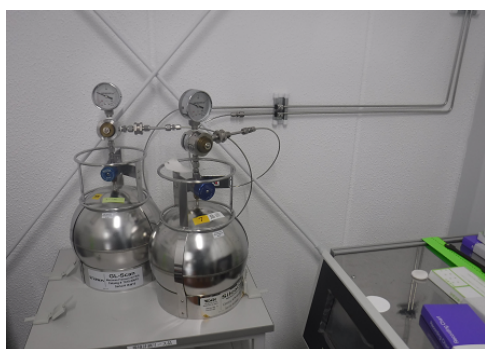
写真 6 有害大気汚染物質調査【左：VOC 採取（屋内）、右：重金属等採取（屋上）】
