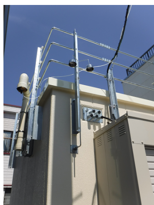
写真3 大気採取部（左：一般大気用、右：VOC用）
