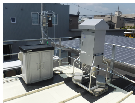
写真 6 有害大気汚染物質調査【左：VOC 採取（屋内）、右：重金属等採取（屋上）】
