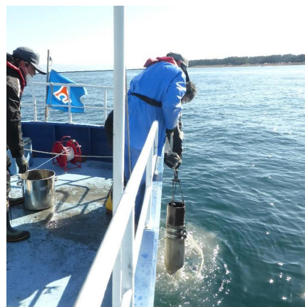
図1 清水港での底質試料採取の様子
