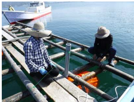
図6 底層溶存酸素量の連続モニタリング
