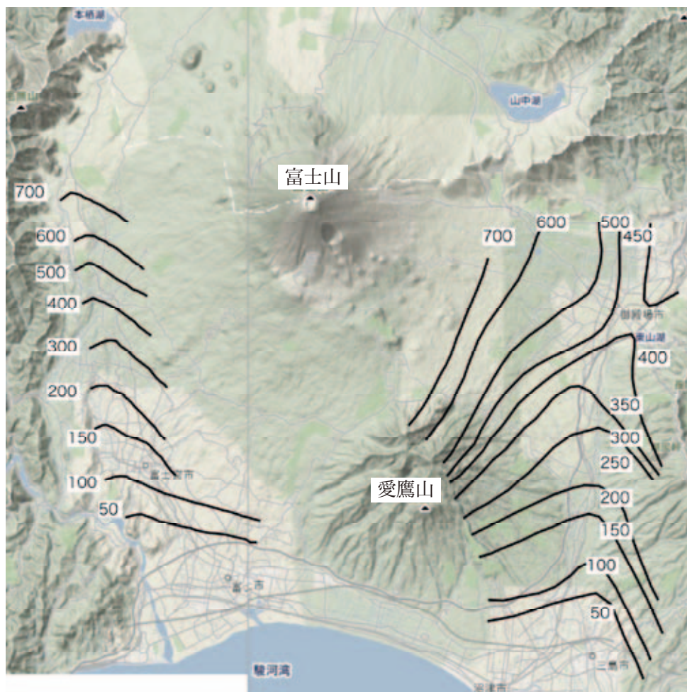
図12 富士山西南・東麓の地下水位等高線図 32, 33, 34, 35) 数値は等高線の標高 (m)
