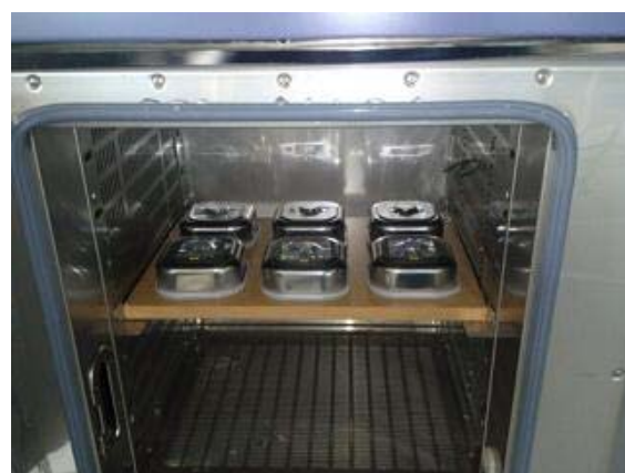
図 2 恒温恒湿槽でのホルムセンサの温度特性試験
