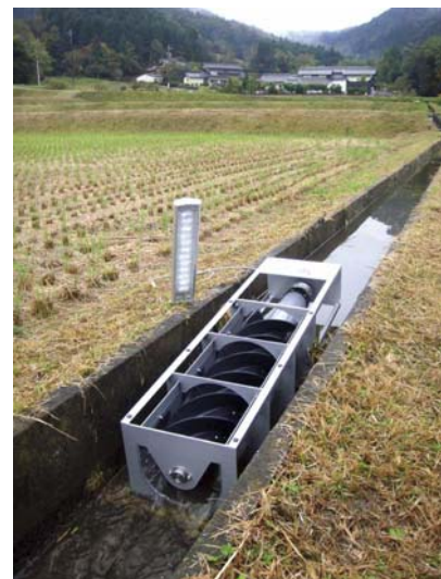
写真 1 小型発電システム「ピコピカ」 (出典 NPO 法人地球の未来)
