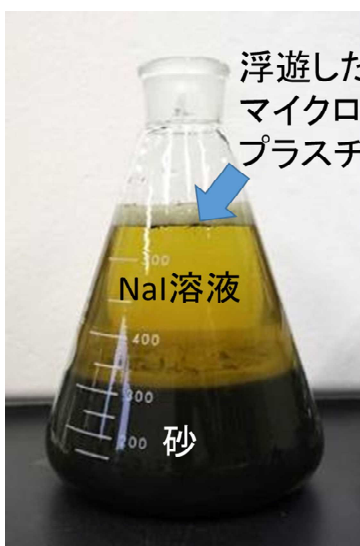
図 2 比重分離による砂からの分離 図 3 海中のマイクロプラスチックの採取
